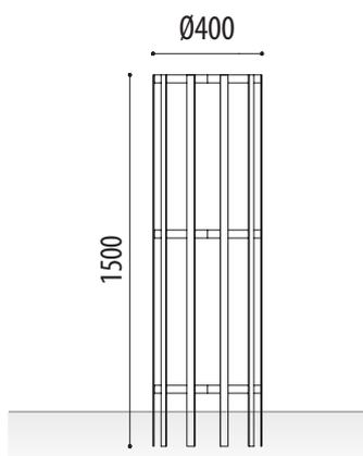
**Protector para árboles Sauce** construido a partir de pletinas horizontales curvadas y pletinas verticales. Fabricado en hierro imprimado más lacado color a elegir. Se suministra en 2 piezas para unir mediante tornillería.
